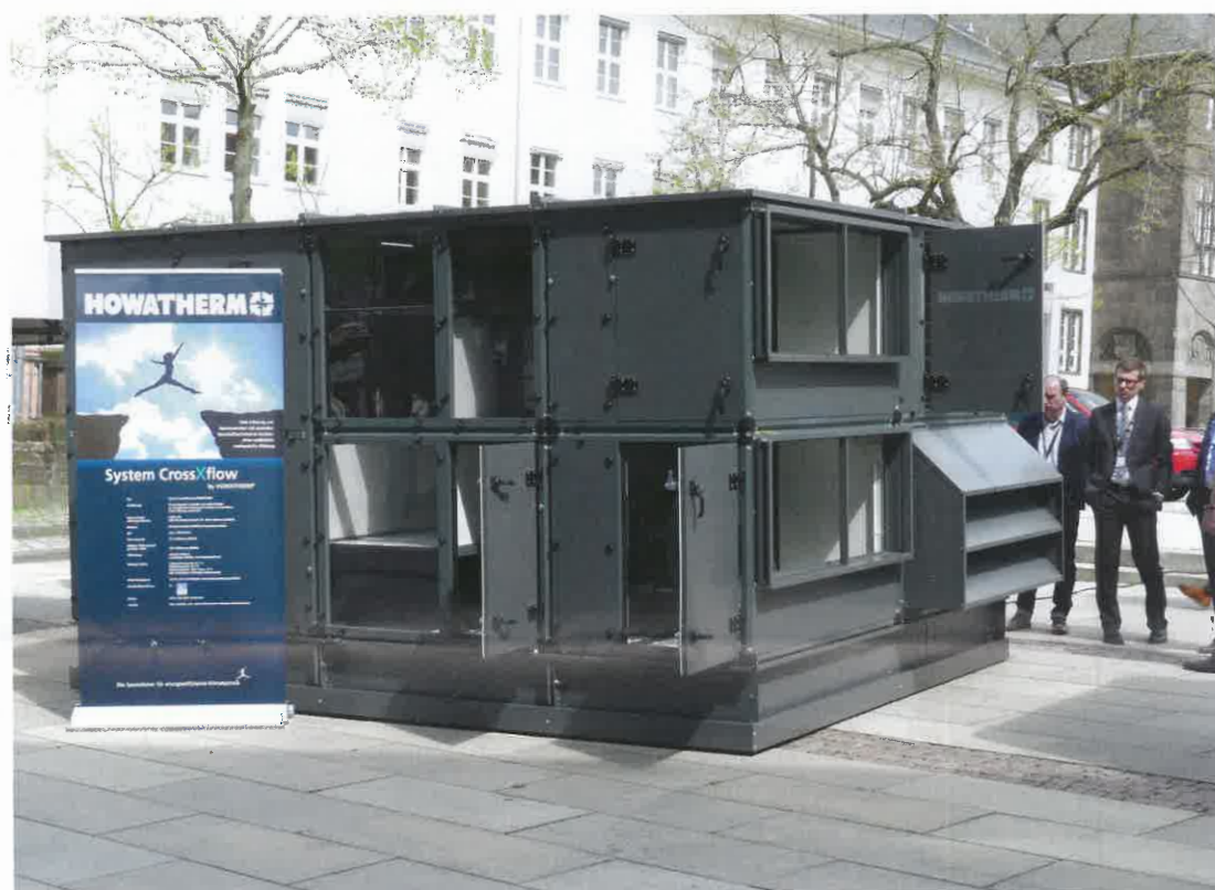
Die Howatherm Klimatechnik hat ihr Produktangebot um RLT-Geräte der Baureihe „CrossXflow“ erweitert, die mit Luftleistungen von 1.000 bis 50.000 m 3 /h speziell für Einsätze in Rechenzentren entwickelt wurden. Kernelemente der Geräte sind eine zweifache Wärmerückgewinnung [nebeneinandergeschaltete H1-Kreuzstromwärmeübertrager], eine zweifache indirekte Verdunstungskühlung und eine Steuerung, die auf Basis der Zustände der Außenluft und der Rechenzentrumsabluft alle Prozesse inklusive der freien Kühlung in den jeweils optimalen Betriebspunkt steuert. Der Anbieter verspricht ganzjährige Zulufttemperaturen zwischen 18 und 24 °C ohne Betrieb einer mechanischen Kälteanlage.
